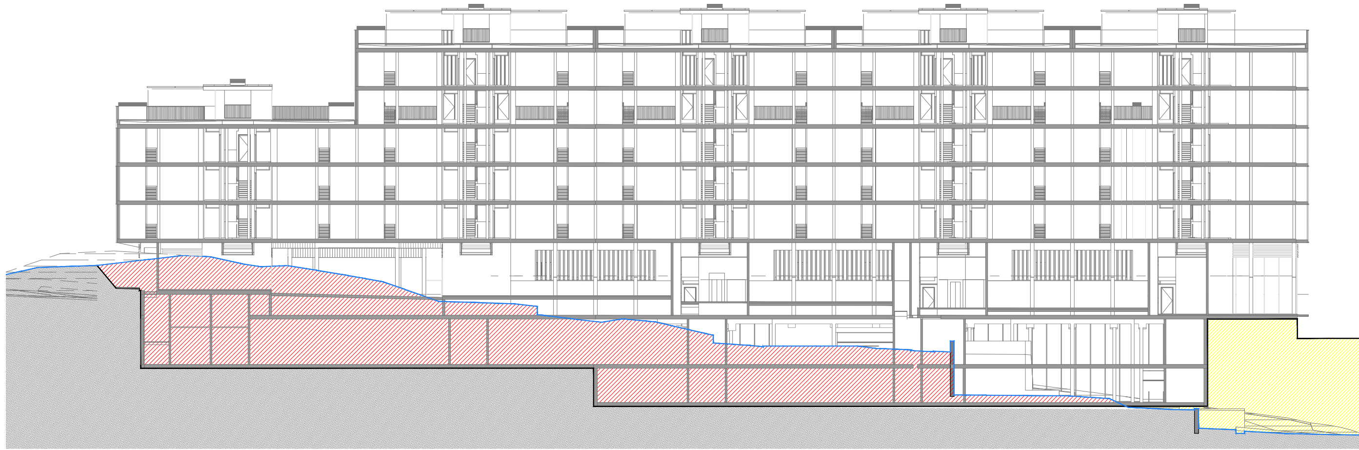
SECCIÓ LONGITUDINAL 02 1 : 1000 EXCAVACIÓ: 429,82 m 2 REOMPLERT: 111 m 2
